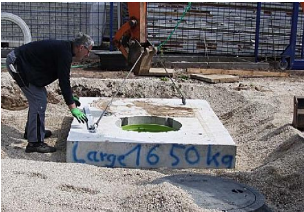
Bild 16: SLW60-Versuch LARGE mit Stb-Platte
