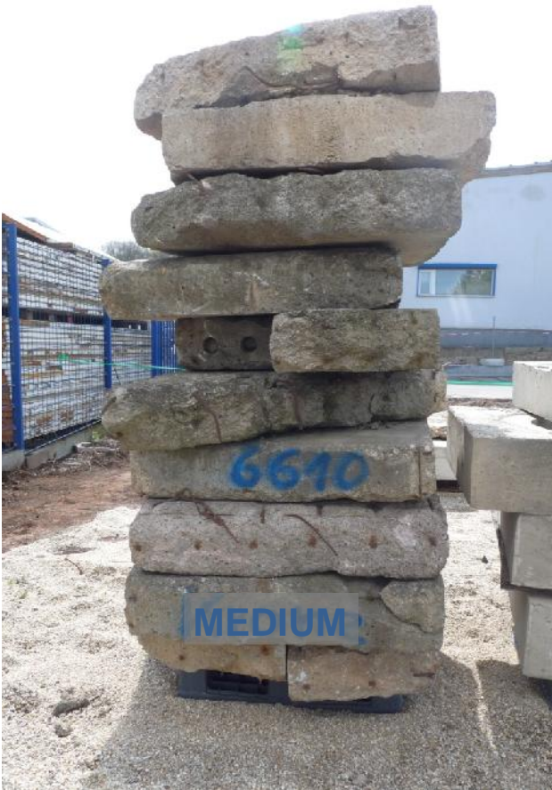
Bild 13: Auflasten MEDIUM 6,6 t
