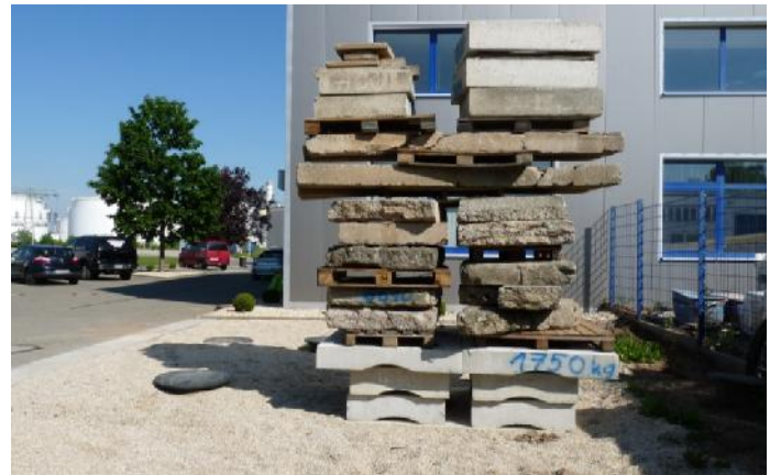
Bild 17: LARGE mit angefüllter Abdeckplatte und 15,5 t Auflast, Beginn am 05.05.2014
