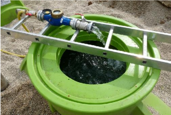
Bild 7: Volumenbestimmung über Wasserfüllung mit geeichter Wasseruhr am XL
