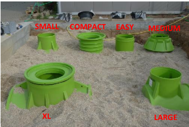
Bild 9: Teilgefüllte Prüfgrube mit allen Behältern
